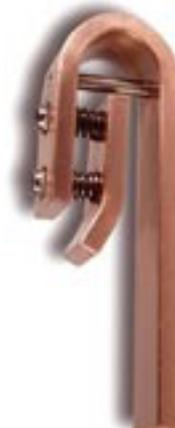
Der **ERKO**<sup>®</sup>-Kontaktkopf FK wird von oben nach unten auf die Waren- bzw. Kathodenschiene geschoben. Eine gefederte Spannplatte preßt die Warenschiene gegen die Kontaktfläche des Kontaktkopfes.
