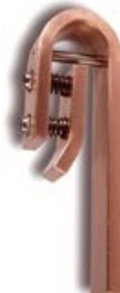
Der **ERKO**<sup>®</sup>-Kontaktkopf FK wird von oben nach unten auf die Waren- bzw. Kathodenschiene geschoben. Eine gefederte Spannplatte preßt die Warenschiene gegen die Kontaktfläche des Kontaktkopfes. Die Kontaktköpfe müssen für die jeweilige Warenschienebreite ausgelegt sein. Diese sollten einen Toleranzbereich von  $\pm 0,5$  mm nicht über- bzw. unterschreiten. Die Federvorspannkraft vergrößert sich nicht bei einer Erhöhung des Warenträgergewichtes.
